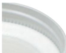
金属製ネジキャップの内面にはコンパウンドと呼ばれる樹脂が塗布されています(空カンを除く)。これは気密性や液漏れ防止の役割を果たしています。
